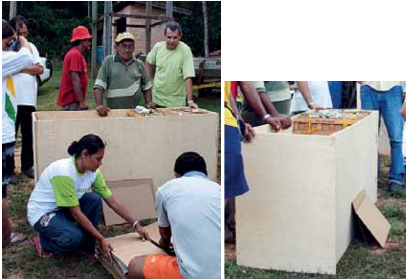
Figura 10: Estufa improvisada para pré-secagem do material botânico no campo Fonte: LMF/INPA
