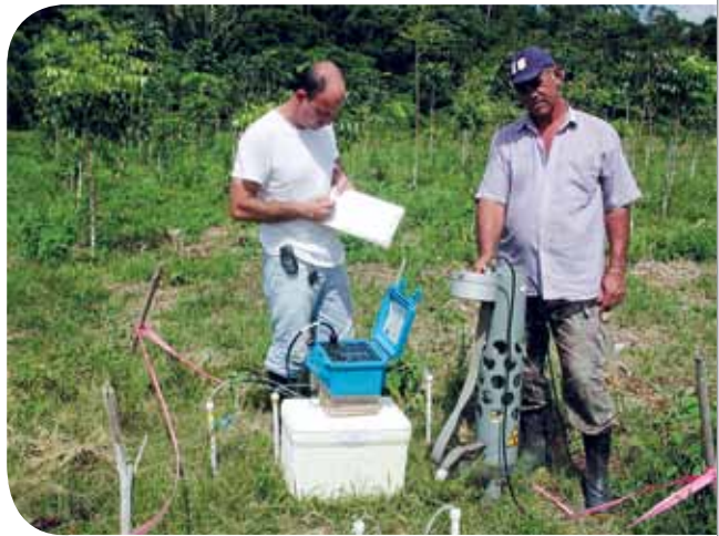
Figura 6: Medidores de umidade do solo: TDR e Sonda de Nêutrons. Fonte: Vânia Neu.
