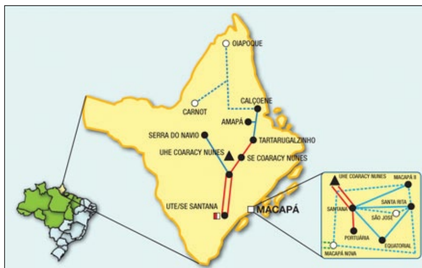
Figura 6: Sistema de transmissão da Eletrobrás Eletronorte no Amapá conta com a UHE de Coaracy Nunes, a UTE Santana e nove subestações (Eletrobrás 2014b).
